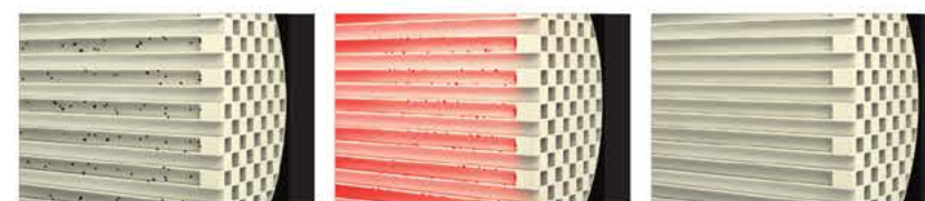
1. Zachycení pevných částic 2. Zahájení regenerace 3. Dokončení regenerace*
