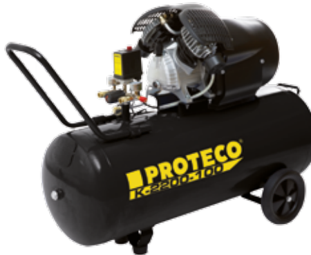
Objem vzdušníku 100 l Pracovní tlak 8 bar Hmotnost 54 kg
