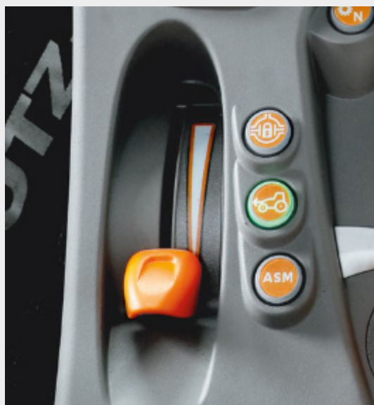
Nezávislá páka ručního plynu a elektrohydraulická aktivace uzávěrek diferenciálů, pohonu všech kol a funkce ASM.
