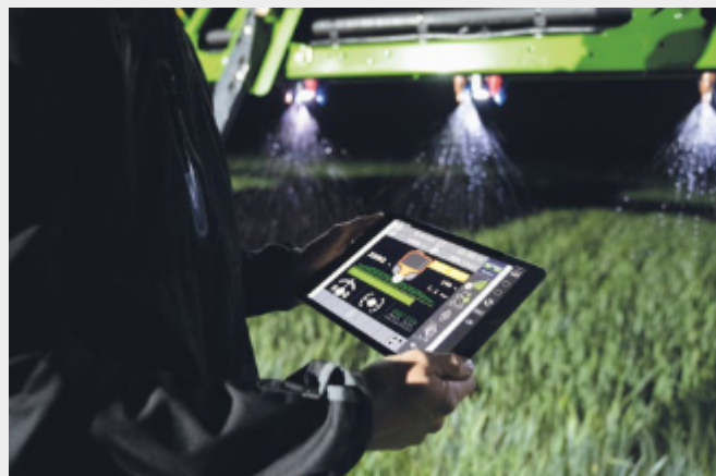
↑ Funkce Xtend, ovládání nářadí pomocí ISOBUS prostřednictvím tabletu, když jste mimo kabinu.
