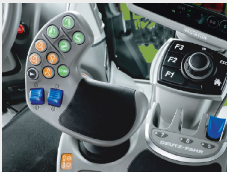
↑ Ergonomický joystick MaxCom, tlačítka tříbodového závěsu (TBZ), ovládání motoru a převodovky, tlačítkem souvratového managementu a ovládacími prvky dvou proporčních hydraulických okruhů.
