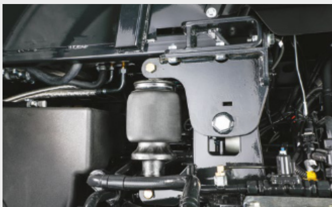
↑ Měchy komfortního vzduchového odpružení kabiny.
