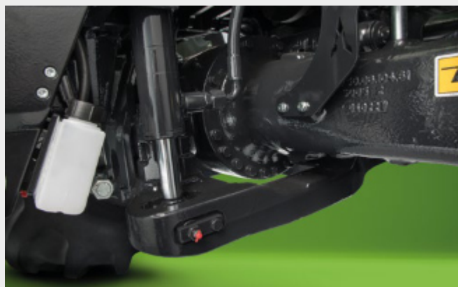
↑ Přední náprava 6190 TTV s robustním spodním kyvným ramenem.
