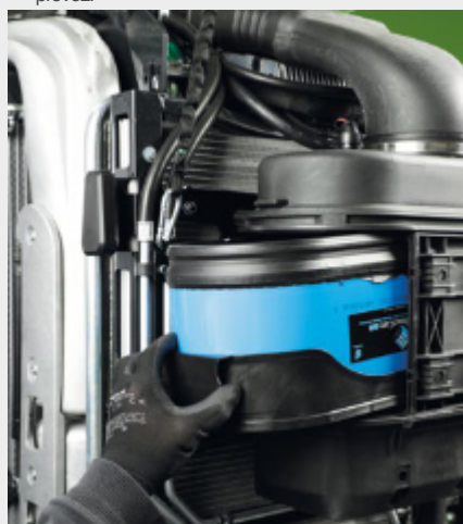
↑ Vzduchový filtr s předčisticí jednotkou.
