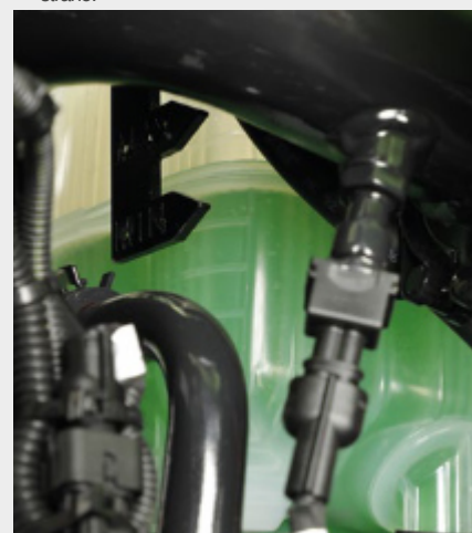
↑ Nádrž na vodu s celovými ukazateli hladiny.
