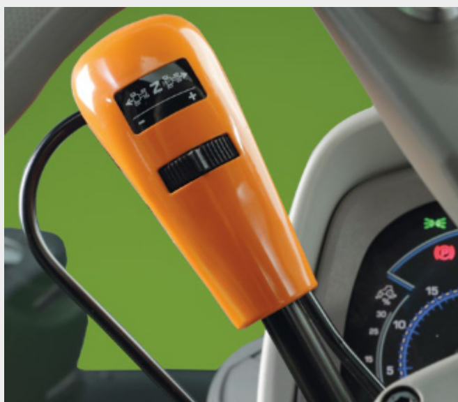
↑ PowerShuttle se spojkou SenseClutch a pěti úrovněmi nastavení.
