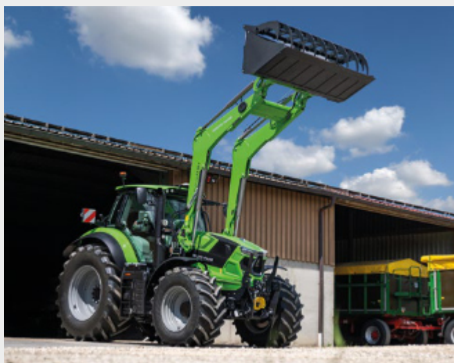
↑ Maximální výška zdvihu 4,5 m a vylamovací síla 37,7 kN.
