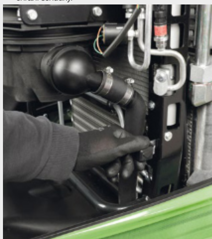
↑ Soubor chladičů s lehce přístupným otevíracím mechanismem.
