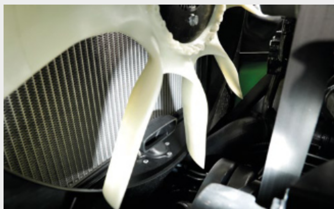
↑ Elektronický viskózní ventilátor (eVisco) se sací hadicí pro systém předčistění vzduchového filtru (odstraňuje 95 % hrubých částic dřeva, než se dostanou k filtrům)..
