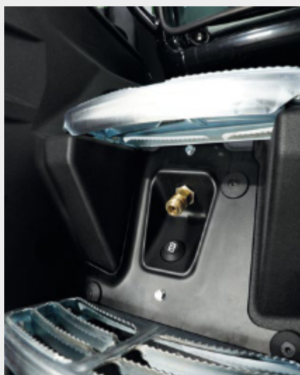
↑ Vývod stlačeného vzduchu a vypínač vstupního světla chrání schůdky.
